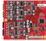
Tesira EIOC-4 Tarjeta de expansión
