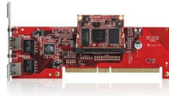
Tesira DAN-1. Tarjeta de audio digital DANTE
