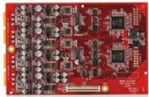
Tesira EEC-4. Tarjeta de expansión
