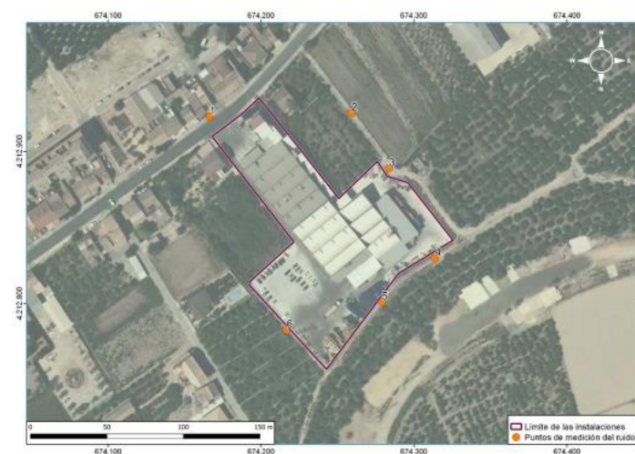
Figura 19. Puntos de medición del ruido. Fuente: Certificado de control del ruido de SGS TECNOS
